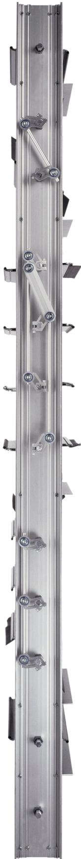
1. Le cadre est fait d'aluminium extrudé (6063-T5) d'une épaisseur minimale de 0,08 po (2,03 mm). Sa profondeur est de 4 po (101,6 mm), avec des brides d'assemblage de 1 po (25,4 mm) de largeur des deux côtés du cadre.
